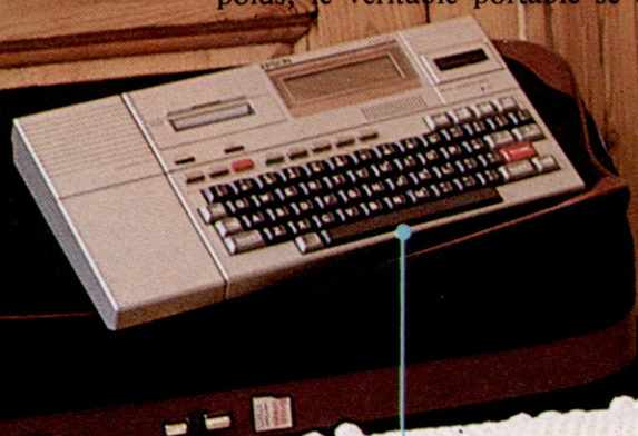
Epson HX-20 Malgré la petite dimension de son écran, le HX-20 offre l'avantage d'une unité à cassette et d'une petite imprimante intégrées. Un modeste programme de traitement de texte est aussi inclus.
